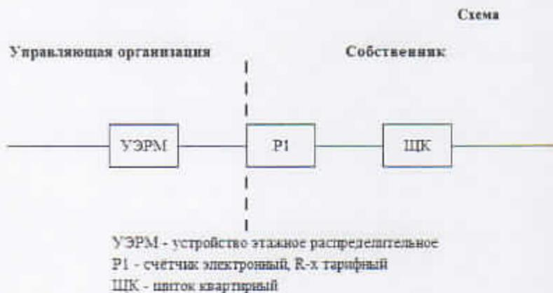
Исполнитель несет ответственность за надлежащее состояние и работоспособность питающих электрических сетей на квартиру согласно нижеуказанной схеме до прибора учета (пунктирной линии слева).
